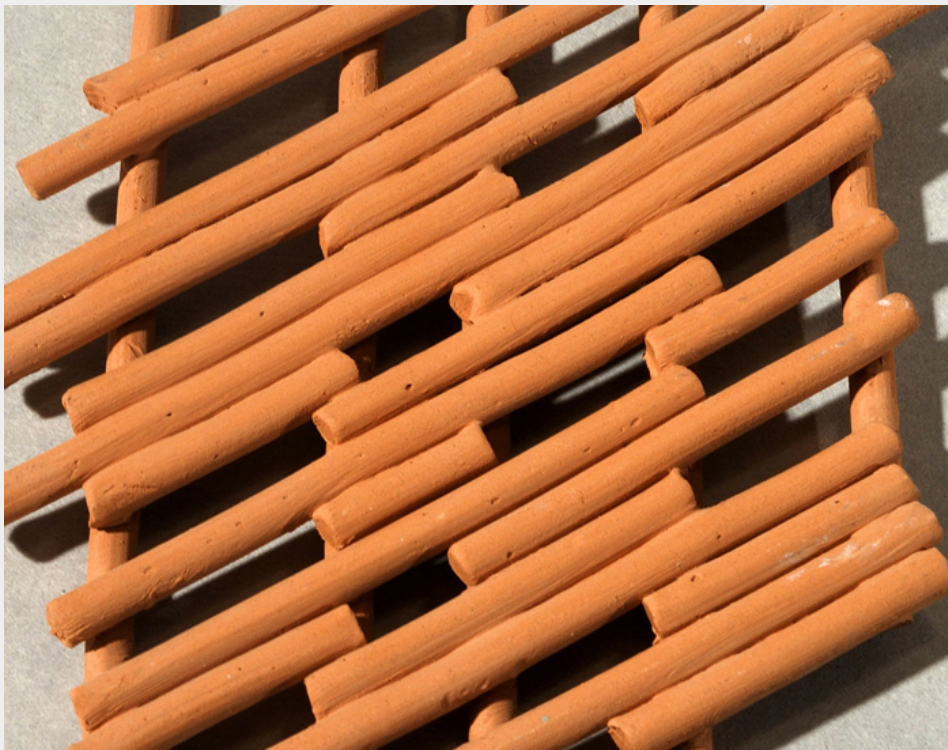
Verifica sperimentale dei limiti di tenuta degli incroci in una semplice tessitura lineare-discontinua. Foto E. Guida/Archivio Guida.
