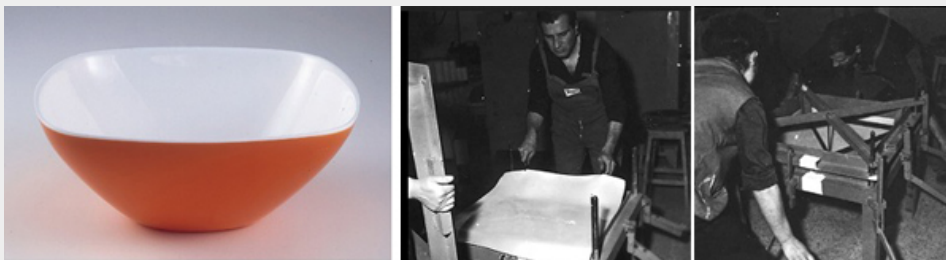
A sinistra, contenitore per usi domestici realizzato mediante termoformatura di lastra bicolore opalina in PMMA, progetto interno di Giovanni e Raimondo Guzzini, 1952. Proprietà Fratelli Guzzini. A destra, fasi della termoformatura della lastra bicolore. (Fonte delle immagini: www.archivio.fimag.it ).
