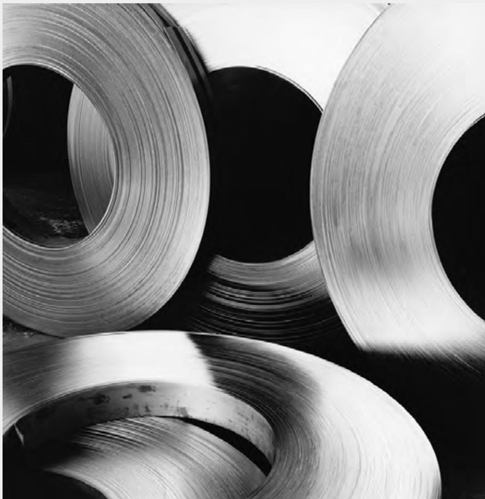
Coils di acciaio inox per la fabbricazione di tubi saldati. 1972. © Dalmine Spa. Archivio Fondazione Dalmine
