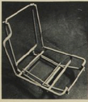
SO SCRIBITTO: sezione del nuovo sedile imbottito della Fiat 500 mod. B e C, detto "Topolino".
